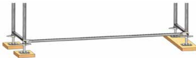
Bild 7: Aufbau des ersten Gerüstfeldes: Längsriegel
