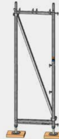
Bild 14: Vertikalrahmen mit Querdiagonale.
