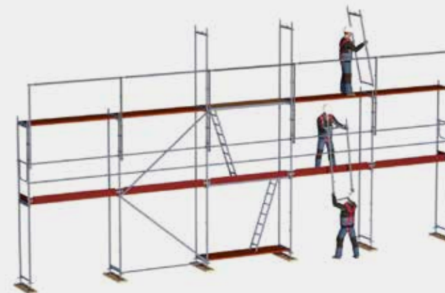
Bild 25: Beispiel für den Vertikaltransport von Hand.
