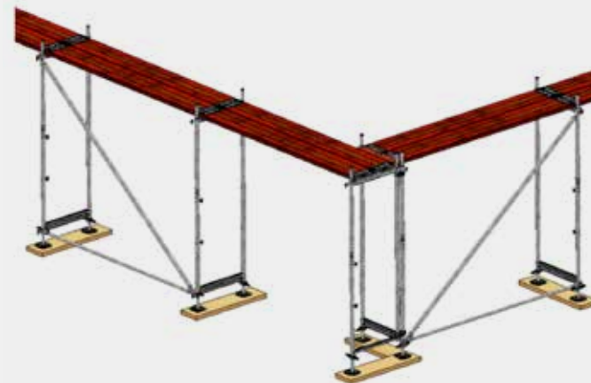
Bild 18: ECKAUSBILDUNG mit zwei Vertikalrahmen
