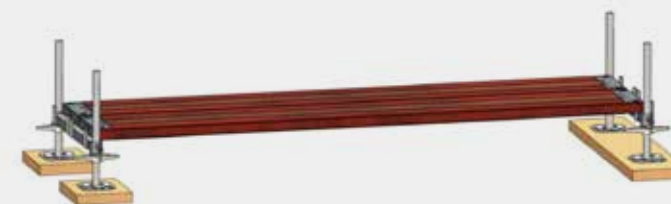
Bild 4: Systembeläge auf Belagtraversen
