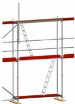
Bild 26: Montage des ersten MSG-Pfostens.
