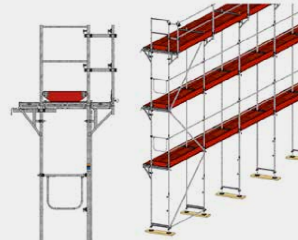
Bild 51: Gerüst mit einbohliger Verbreiterungskonsolen außen und innen
