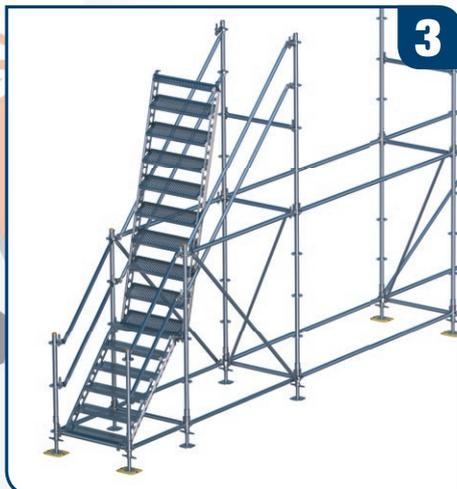
Die Treppen werden zuerst unten auf den Riegel gesetzt und dann so gekippt, dass die Auflage oben ebenfalls auf einem Riegel liegt.
