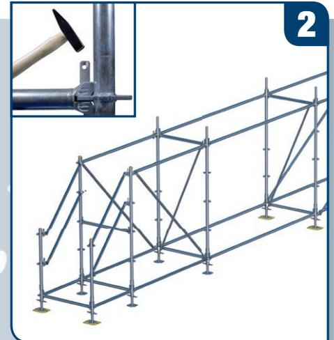
Beim Aufbau die Diagonal-Riegel so früh wie möglich einsetzen. Ohne diese Bauteile ist Ihr Gerüst nicht standsicher!
