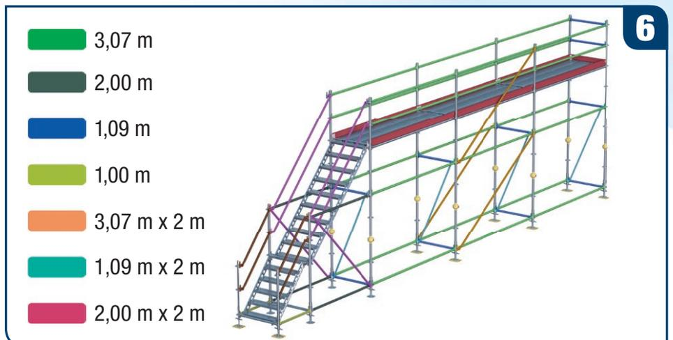
Das komplette Gerüst mit den verschiedenen langen Bauteilen. Achten Sie darauf, dass die Geländerriegel auf der Stirnseite – ganz hinten am Laufsteg – ebenfalls montiert sind!
