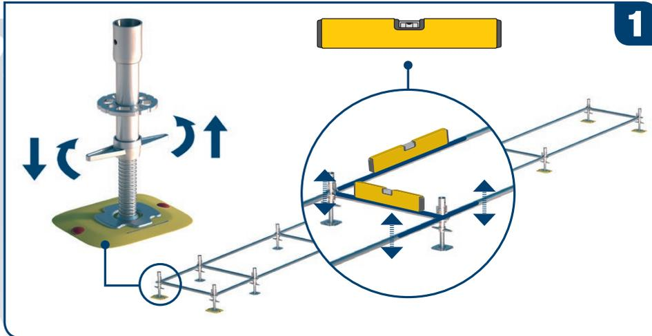
Nach exakt horizontaler Ausrichtung der unteren Riegelgange in Längs- und Querrichtung wird der Restaufbau zum Kinderspiel. Durch Hoch-/Runterschrauben der Muttern am Gewindefuß lassen sich Unebenheiten des Untergrundes ausgleichen.
