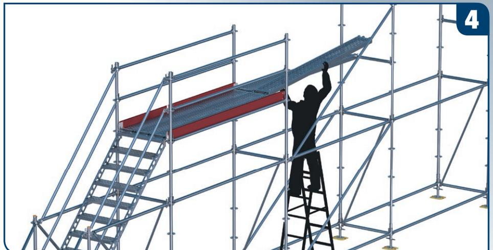
Die Bohlen von unten mittels einer Leiter einlegen. Montieren Sie das Gerüst immer komplett (die Anzahl der Anbaumodule kann variieren), um die optimale Sicherheit zu gewährleisten! Setzen Sie direkt beim Betreten der oberen Lage alle Geländerriegel ein.
