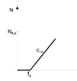
Bild 4: bilineare Federkennlinie
